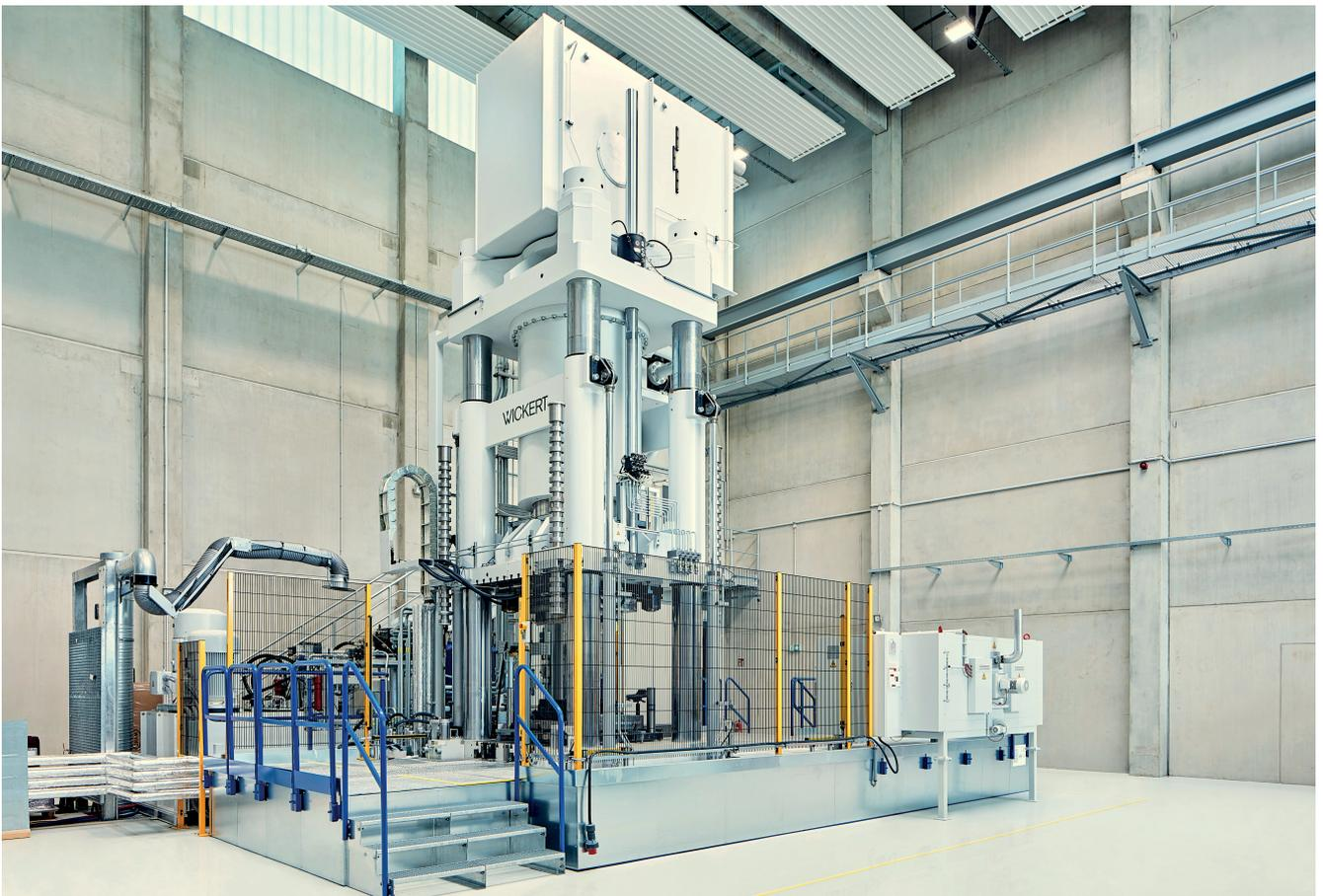
Composite-Pressen für die Forschung: Wickert entwickelte für Wissenschaftler an der TU Chemnitz eine hochflexible Viersäulen-Oberkolbenpresse, die umfassende Freiheiten und vielfältige Einsatzmöglichkeiten bietet © TU Chemnitz
