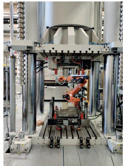
**Bild 2.** Die Wissenschaftler können Abläufe auf Wunsch jederzeit automatisieren. Dafür hat Wickert ein Roboterhandling installiert und in die Maschinensteuerung eine Reihe zusätzlicher Schnittstellen integriert © TU Chemnitz
