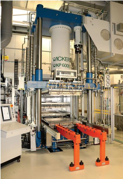
**Bild 3.** Aus Organosheets werden beim Forschungsinstitut Neue Materialien Bayreuth (NMB) 3D-Bauteile: Composite-Pressen für Hochleistungsthermoplaste mit Verarbeitungstemperaturen von bis zu 450 °C © Wickert
