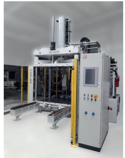
**Bild 4.** Dachhimmel für PKWs werden auf Pressen von Wickert wie dieser WKP 1500 S gefertigt – zum Teil sind naturfaserverstärkte Kunststoffe (NFK) enthalten © Wickert
